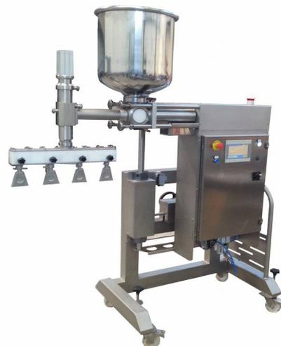
La dosatrice volumetrica elettronica (DVE) dispone di un dispositivo di pompaggio a siringa azionato da motore brushless e controllato da software su touch screen. Può lavorare in linea sul trasportatore o indipendente a banco. Tra i principali vantaggi:
